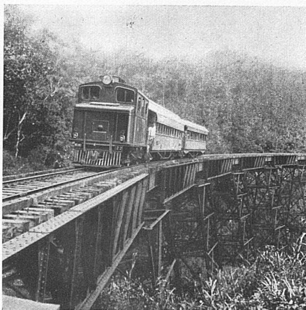
Eine der an die Siamesischen Staatsbahnen gelieferten 200 PS Diesellokomotiven „S. L. M.-Winterthur“, seit Juni 1928 im Betrieb
