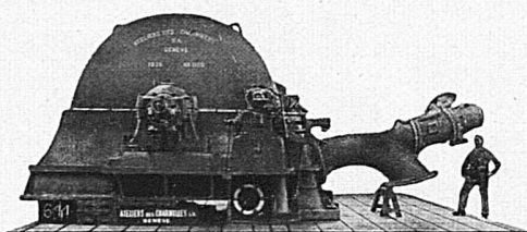
Une des turbines Pelton de 20 000 CV. fournies aux CHEMINS DE FER FÉDÉRAUX pour l'Usine de Vernayaz (Valais)
