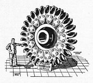
—→ ROUE D'UNE DES TURBINES DE 20000 cv.
