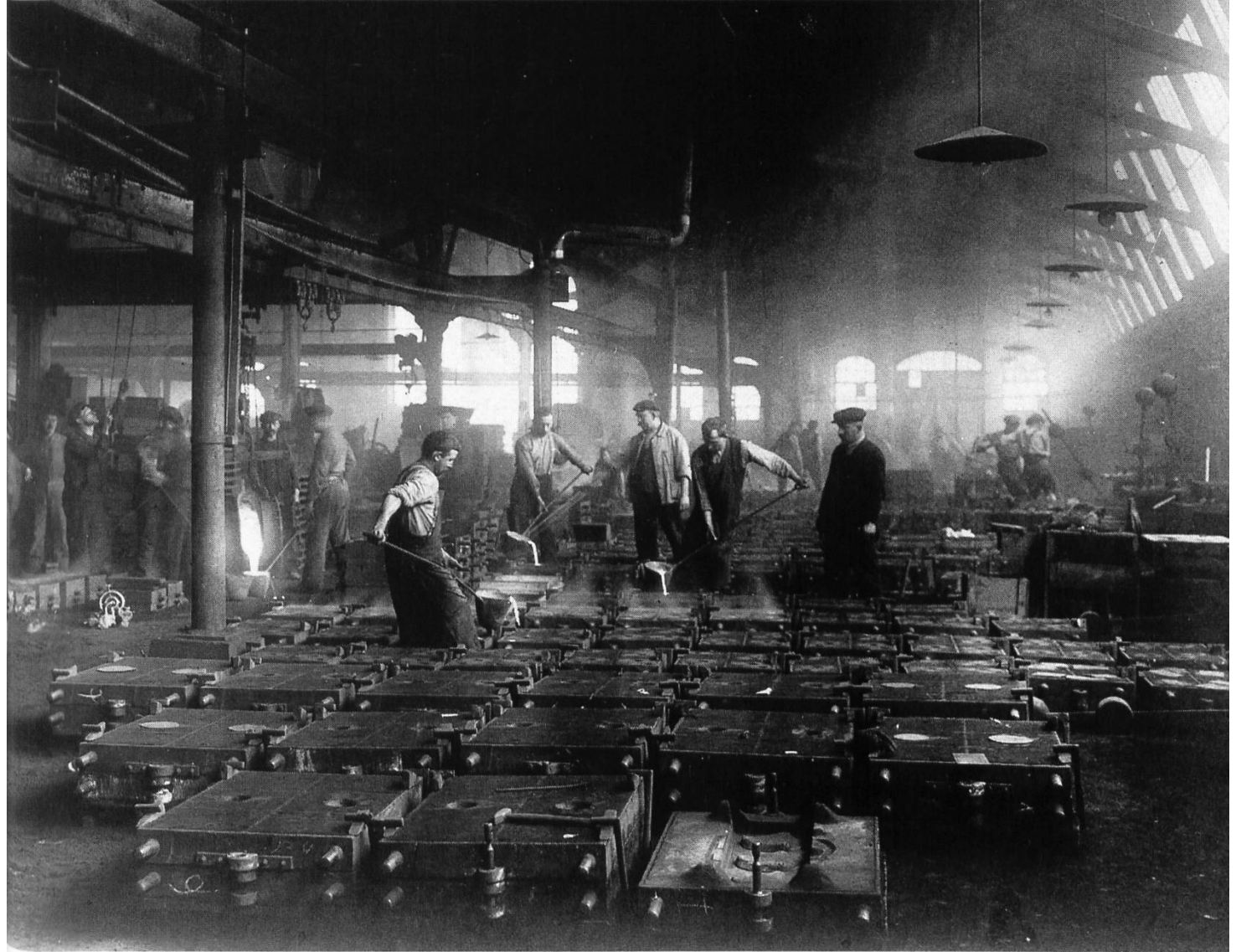
Bereits zu den ersten Erweiterungsbauten der Ofenfabrik gehörte die Giesserei. Das Unternehmen war stolz darauf, dass es selber alle Zubehörteile produzieren konnte.
