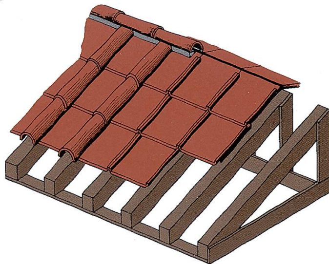
Abb. 17 Rekonstruktionszeichnung eines römischen Ziegeldaches.
