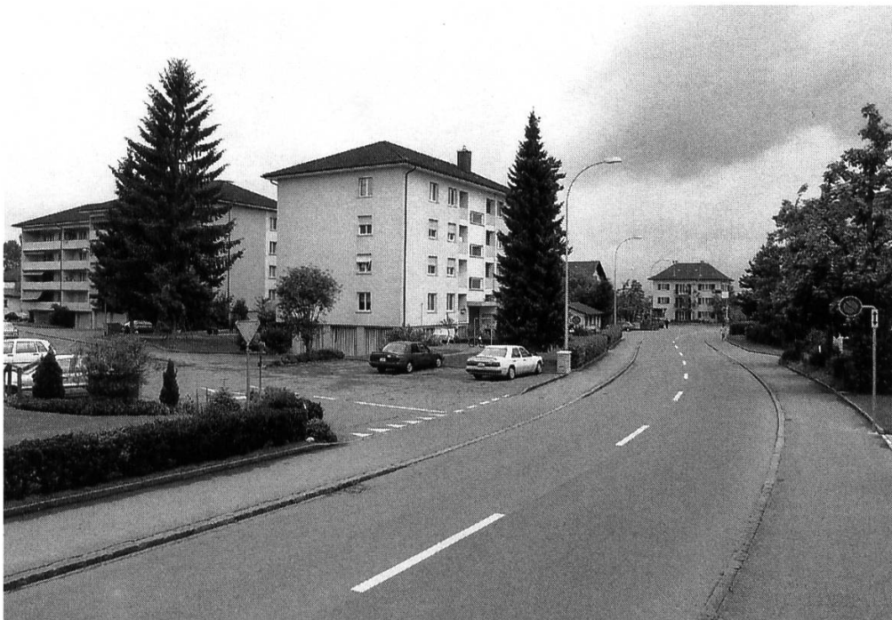
Ein Grossteil der kubischen Mehrfamilienhäuser mit Flachdach erhielten bei der Sanierung ein Satteldach. Aufnahme 1997.
