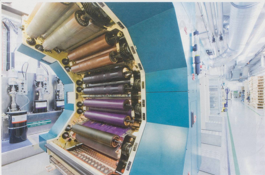
Machine destinée à l'impression sécurisée des billets de banque suisses.
