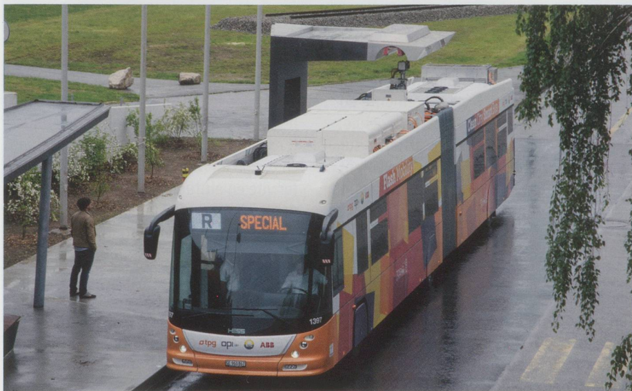
Le bus TOSA et sa station d'alimentation
