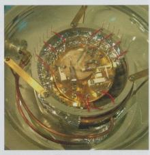
Microscope à effet tunnel
