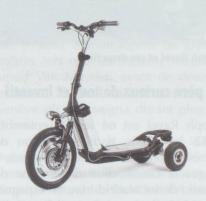
arrière s'inclinent dans les courbes, rendant l'engin particulièrement maniable, notamment en ville. Pour les amateurs de golfs ou de sentiers, un modèle spécifique arbore des roues plus larges et plus grandes. Malin aussi, le pliage qui permet au E-Bikeboard d'entrer facilement dans le coffre d'une petite voiture, voire de voyager dans le train.
