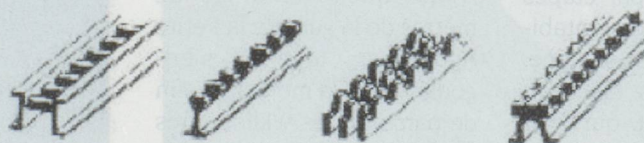
Différents systèmes de crémaillères. De gauche à droite : Riggienbach, Strub, Abt, Locher
