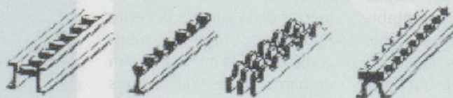
Différents systèmes de crémaillères. De gauche à droite : Riggenschach, Strub, Abt, Locher
