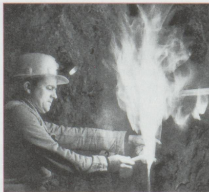
Démonstration de l'allumage du grisou capté dans certaines galeries.
