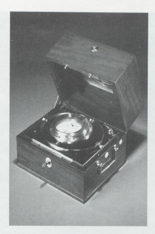
Chronomètre de marine à deux barillets, réalisé dans une boîte étanche et monté sur cardans dans un coffret d'acajou. Modèle acheté par le Ministère de la Marine française entre 1827 et 1831.
