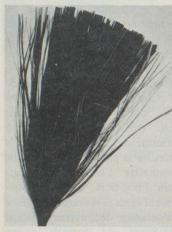
en fibres de carbone. Sur la photo, on voit l'extrémité d'un fil de fibres, d'un diamètre de six millimètres, qui est composé d'un demi-million de fibres de carbone. Chacun des câbles porteurs du pont suspendu serait composé de 400 de ces fils (photo EMPA).
