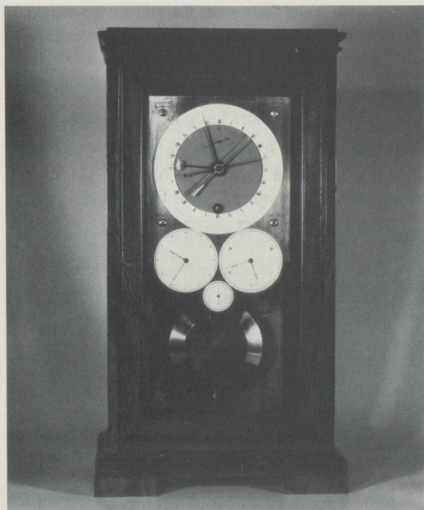
Horloge astronomique à 4 cadrans avec double tour d'heures : décimal et sexagésimal, quantième, lever et coucher du soleil à Paris, lat. 48° 50' 15". Mouvement à clé, à ressort. Echappement à cheville. Pendule compensateur à grill. Suspension à couteau. Antide Janvier, au Louvre n° 347, Paris, 1802 1751-1835
