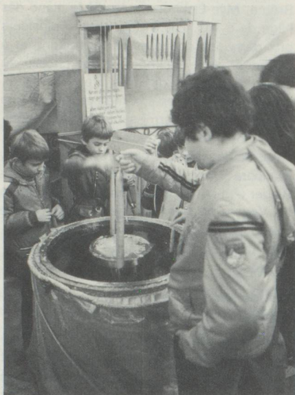
Plusieurs personnes peuvent travailler simultanément autour de la cuve, chauffée par un alliage conducteur, qui contient la cire fondue.
