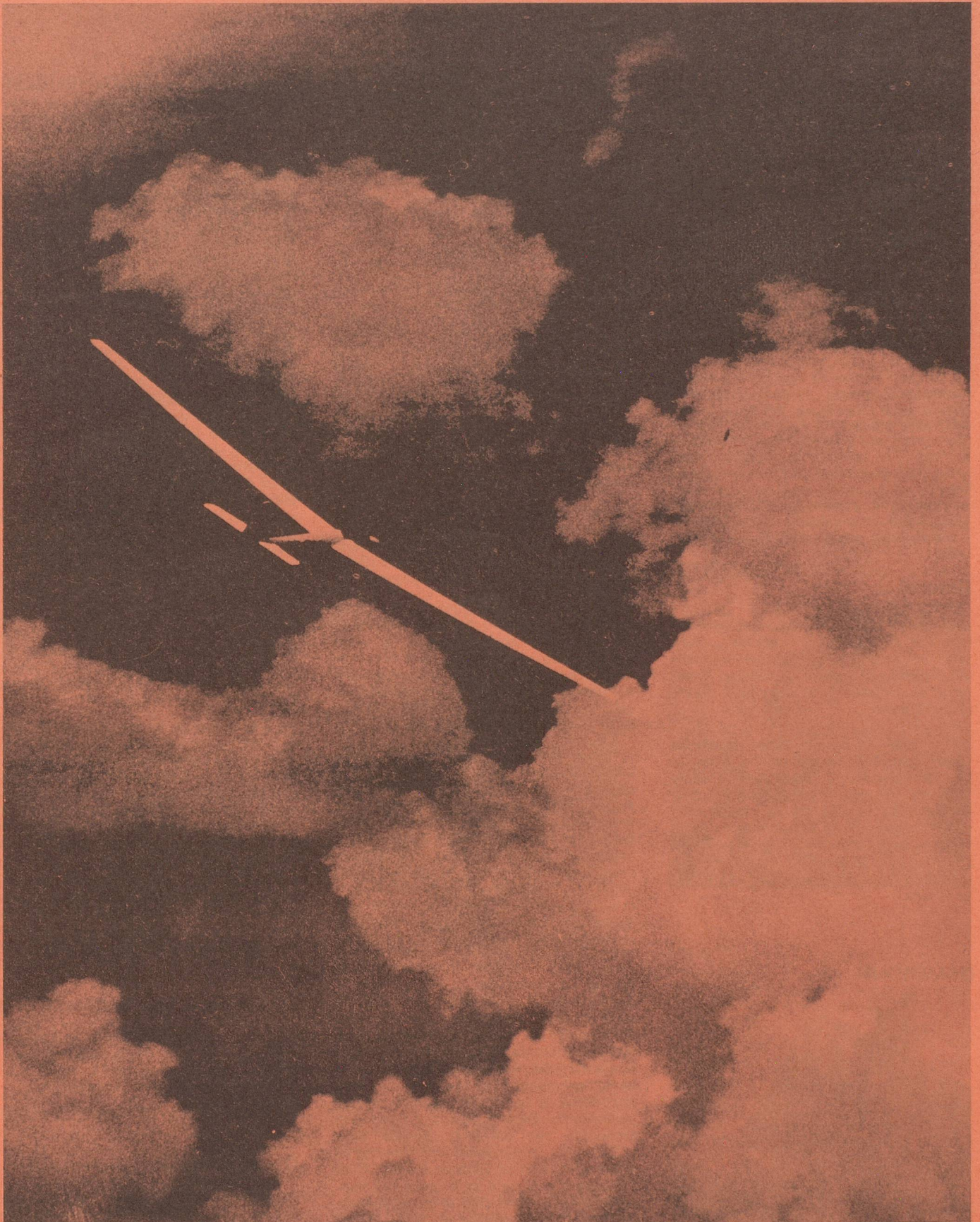
3. : « Cumulus : base 2 000 - bonnes conditions thermiques. » Libellule, planeur de haute performance en matière plastique. Vitesse de descente verticale environ 58 cm à la seconde. Reportage ONST.
