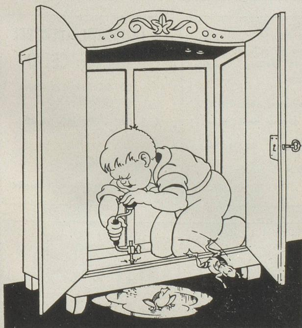
Pour éviter l'humidité des armoires ou placards dans les maisons de campagne. Pécutez des ouvertures dans le haut et le bas du placard, les recouvez d'une toile métallique fine afin d'empêcher le passage des insectes.
