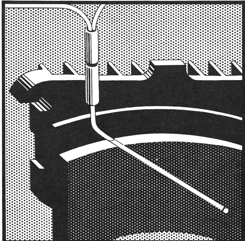
Das ist ein Bremsbelag. Aber nicht irgendeiner. Das ist ein Bremsbelag des Citroën DS 21 - ein Bremsbelag mit eingegossenem Abnutzungsanzeiger. Ein elektrisches Kabel in dem Belag bringt bei einem bestimmten Verschleiß ein Kontrollämpchen auf dem Armaturenbrett zum Aufleuchten.
