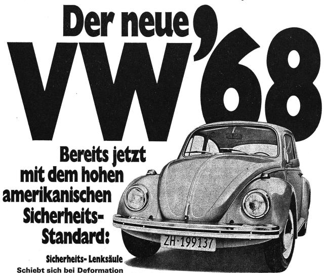
Schiebt sich bei Deformation des Vorderwagens zusammen. Erhöhte Sicherheit für den Fahrer.
