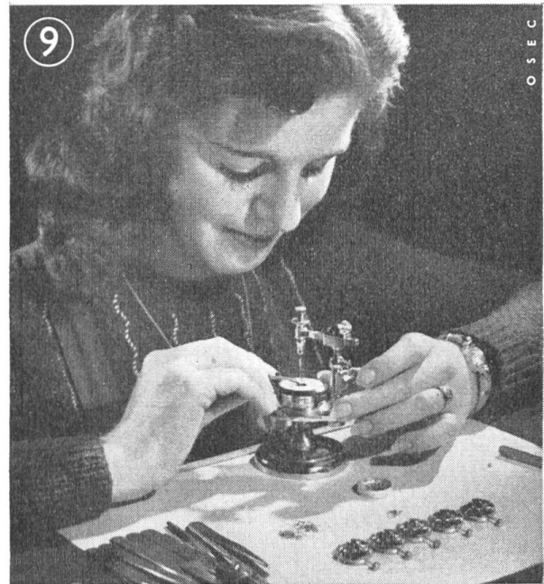
Das Ausregulieren der haarfeinen Spiralfedern.
