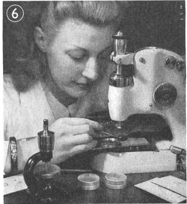
Einsetzen der Uhrsteine (Rubine).
