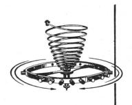
432 000 Schwingungen im Tag! Die besonders große, aus 31 Teilen zusammengesetzte Unruhe ist aus harter Berylliumbronze. Statisch und dynamisch vollkommen ausgewuchtet (Millionstelgramm spielen da eine Rolle!), ist eine solche Un1uhe — in Verbindung mit der selbstkompensierenden GP-Thermofix-Spirale — Temperatur- und Druckschwankungen gegenüber unempfindlich. Weitere GP-Qualitätsmerkmale erklären Ihnen gerne unsere offiziellen GP-Verkaufsstellen.
