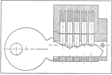
Abbildung 2. Querschnitt durch ein Yale-Schloß. Es wurde der richtige Schlüssel eingeführt. Die Unterbrechungen der fünf Bolzen bilden eine Gerade, der Zylinder des Schlosses (der von links oben nach rechts unten schraffiert ist), läßt sich also drehen.
