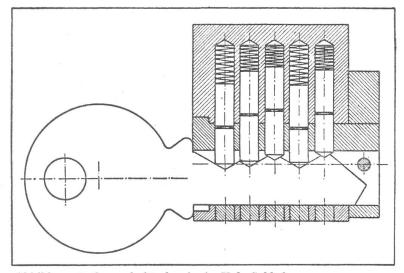
Abbildung 3. Querschnitt durch ein Yale-Schloß. Hier wurde ein falscher Schlüssel eingeführt. Da die Unterbrechungen der fünf Bolzen nicht unter sich und nicht mit dem Schloßzylinder übereinstimmen, kann der Schlüssel nicht gedreht werden.
