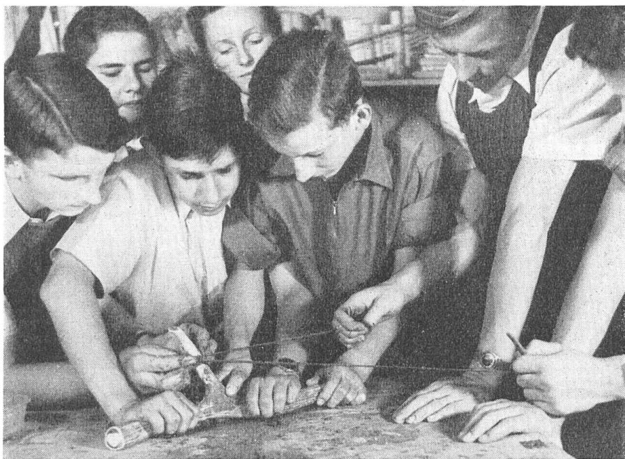
Mittels einer Schnur und feuchtem Quarzsand wird eine Geweihsprosse in kurzer Zeit durchsägt.
