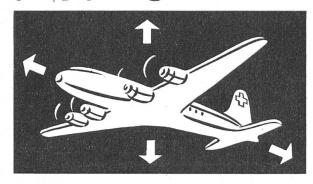
Beim Drachen gelingt's, weil er schräg gegen die Luft steht. Beim Flugzeug verhält es sich, prinzipiell, genau so. Das Höhensteuer stellt die Tragflächen schräg aufwärts. So entsteht ein Druck gegen das Flugzeug, und die Kraft des Motors erzeugt den nötigen Gegendruck. Druck erzeugt Gegendruck. So hebt sich das Flugzeug vom Boden ab, und das dauernde Weiterbestehen dieses Kräftespiels hält das Flugzeug in der Luft, d.h. es hebt die Schwerkraft auf, die das Flugzeug zur Erde ziehen würde.
