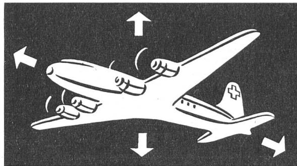
Beim Drachen gelingt's, weil er schräg gegen die Luft steht. Beim Flugzeug verhält es sich, prinzipiell, genau so. Das Höhensteuer stellt die Tragflächen schräg aufwärts. So entsteht ein Druck gegen das Flugzeug, und die Kraft des Motors erzeugt den nötigen Gegendruck. Druck erzeugt Gegendruck. So hebt sich das Flugzeug vom Boden ab, und das dauernde Weiterbestehen dieses Kräftespiels hält das Flugzeug in der Luft, d. h. es hebt die Schwerkraft auf, die das Flugzeug zur Erde ziehen würde.
