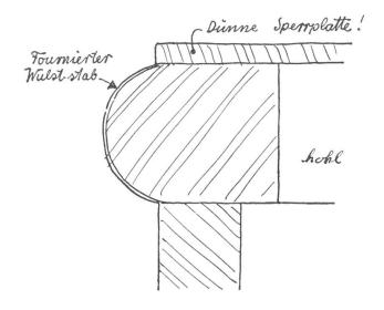
und hier eine der konstruktiv richtigen Lösungen.
