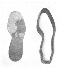
Stanzeisen für die maschinelle Herstellung der Sohle
