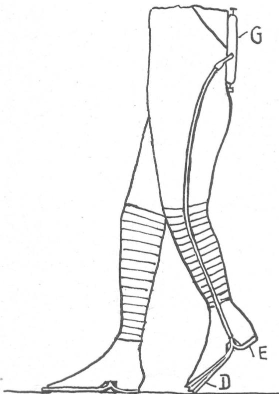
„Vorrichtung zur Nutzbarmachung des Körpergewichtes beim Gehen, dadurch gekennzeichnet, dass an Sohlen und Absätzen der Fußbekleidung Luftpumpen (D u. E) zur Erzeugung von Pressluft angebracht sind, die mittels Verbindungsschläuche in einen Sammelbehälter (G) geleitet wird.“
