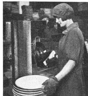
Nach der Aufnahme wird die Wachsmeisterplatte in einem staubsicheren Laboratorium einer speziellen Behandlung unterzogen und hierauf in ein electrolytisches Bad gelegt um das Kupfernegativ, die Matrize, zu erhalten. Es werden drei Matrizen hergestellt: einen „Vater“, eine „Mutter“ und ein „Sohn“. Der Vater kommt ins Archiv, vom Sohn werden die Platten gepresst.
