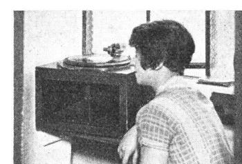
Die aus der Presse kommenden Platten enthalten noch einige kleine Unreinheiten und Poren, die erst wegpoliert werden müssen. Die vollkommene glänzend schwarze Oberfläche der Columbia-Platte, wie Sie sie kennen, ist das Werk der hier abgebildeten Maschine.
