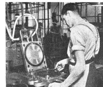
Das ist die automatische Plattenpresse. Der Arbeiter nimmt die Plattenmasse, erhitzt knetet und schiebt sie in die Form. Mit einem gewaltigen Druck von 100 000 bis 150 000 kg. wird die Platte gepresst. Ein Mann stellt mit einer solchen Presse in 10 Stunden 700 Platten her. In den Saisonmonaten arbeiten diese Pressen ununterbrochen Tag und Nacht.
