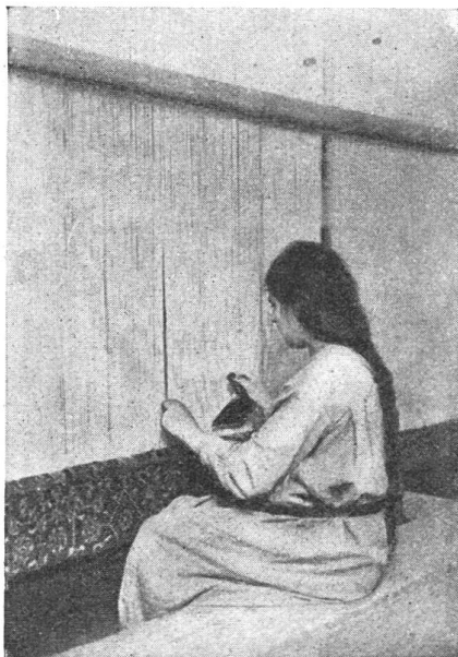
Das Durchziehen des Einschlags. Nach jeder Noppenreihe muss ein Einschlag erfolgen, dieser wird mit gezähntem Hammer niedergeschlagen
