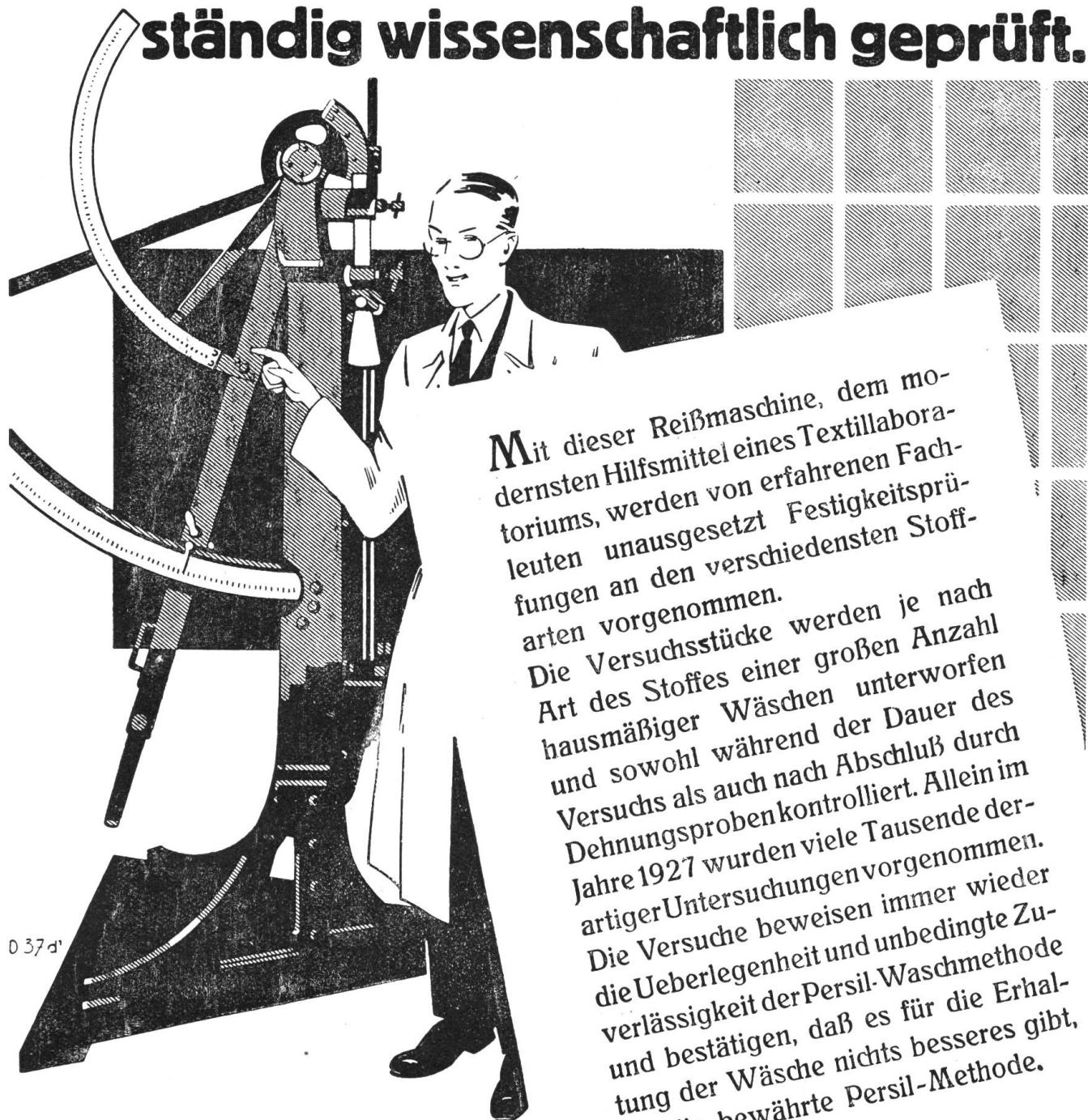
Mit dieser Reißmaschine, dem modernsten Hilfsmittel eines Textillaboratoriums, werden von erfahrenen Fachleuten unausgesetzt Festigkeitsprüfungen an den verschiedensten Stoffarten vorgenommen.
