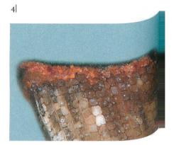
Querschliffe wurden anschliessend mit Ramanspektroskopie untersucht. Diese Untersuchungsmethode erlaubt die Identifizierung von chemischen Verbindungen und damit der verwendeten Pigmente.
