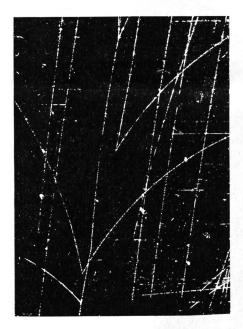
Abbildung 27 Beobachtung des Ω<sup>-</sup>-Hyperons in der Brookhaven (USA) Wasserstoffblasenkammer (s. dazu Text Abbildung 26)
