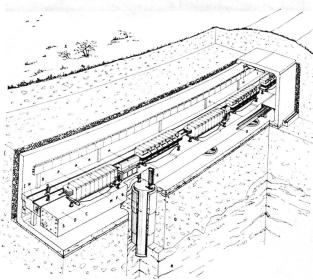
Abbildung 8 Schematische Teilansicht des PS-Rings
