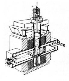
Abbildung 16 Schematischer Aufbau der (200 cm×60 cm ×50 cm) CERN Wasserstoff-Blasenkammer
