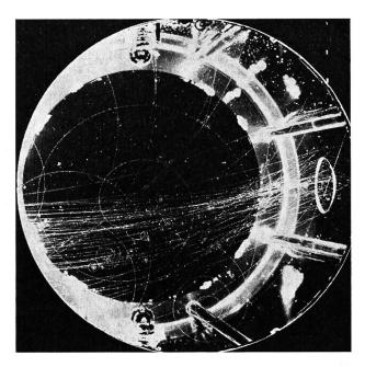
Abbildung 14 Spuren eines μ-Mesonen-Strahls in der CERN Propankammer
