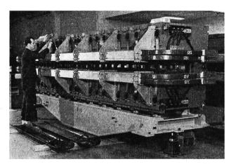
Abbildung 9 Magneteinheit des PS
