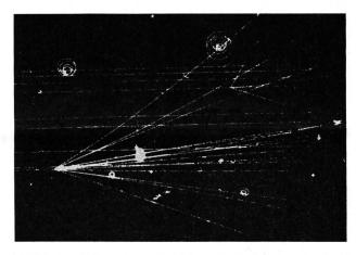
Abbildung 15 Zusammenstoß eines 25 GeV Protons mit einem Proton in der CERN Wasserstoff-Blasenkammer. Bei dem Stoß werden 14 Sekundärteilchen, im wesentlichen Mesonen, erzeugt.
