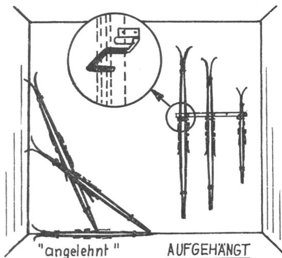
Bis 30 Paare pro m<sup>2</sup>. Jedes Paar jederzeit griffbereit. Skier sind weg vom Boden, daher leichte Reinigung. Einrichten ganzer Skiräume oder Elemente zum Selbstmontieren.
