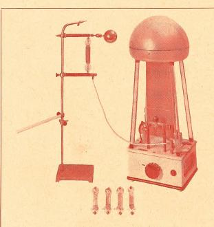
Bandgenerator mit Gegenkugel und Geißlerröhren
