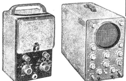
**V-7A Röhren-Voltmeter** für Gleich- und Wechselspannung sowie Widerstandsmessungen. Je 7 Messbereiche von 1,5 bis 1500 V Endauschlag. Skala für Spitzen-Spannungsmessung. Bausatz Fr. 163.—, montiert Fr. 212.50.
