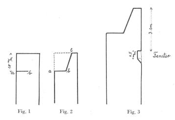
kommen muß. Nachher wird von oben schräg bis zur Schnitt-fläche hinunter gesägt (Fig. 2 von c—b).
