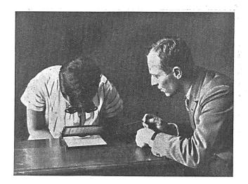
Bild 3: Prüfung des körperhaften Sehens am Stereoskop.
