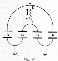
A nach E. Bei D kann der Strom nicht austreten, da er auf Aluminium trifft; er geht somit von E nach F und über C zurück. Die negative Hälfte der Stromwelle tritt bei W1 ein, geht über D nach E und von dort über F und B in die Leitung. Im Leitungsstück E F fliessen die Stromwellen somit in gleicher Richtung.
