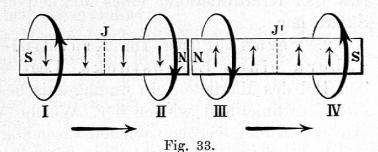
Beobachtung: (Die Nadel schlägt aus.) Schiebt auf 2 \ die Magnete durch die Spule über beide Nordpole weg bis zur zweiten Indifferenzstelle. Beobachtung: (Kräftiger Ausschlag der Nadel in entgegengesetzter Richtung.) Zieht auf 3 \ die Magnete ganz durch. Beobachtung: (Ausschlag der Nadel in der ersten Richtung.)
