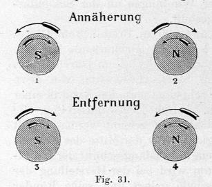
gesetzter Richtung aus.) Ein Schüler halte seine rechte Hand in die Richtung des neuen Induktionsstromes, ein anderer in die Richtung der Ampèreschen Ströme. Beobachtung: (Die beiden Hände haben die gleiche Richtung; die Ströme laufen parallel. (Fig. 313.) Erkenntnis: Beim Entfernen ist der Induktionsstrom den Ampèreschen Strömen parallel.
