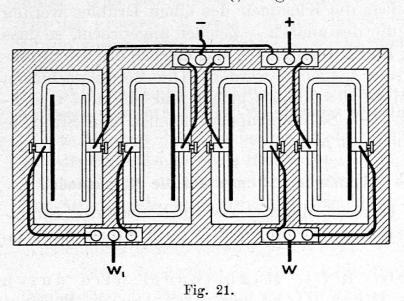
durch 3 Scheidewände in 4 Abteilungen geteilt. In diesen befinden sich 4 Glaszellen von 26 cm Höhe, 17 cm Länge und 6,5 cm Breite (von der Akkumulatorenfabrik Örlikon zu 70 Rappen das Stück geliefert). In diesen stehen die Elektroden. Die
