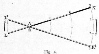
(K), die Gewichte rechts als die zu hebende Last (L), ferner die Entfernung der Kraft vom Drehpunkt als Hebelarm der Kraft (k), die Entfernung der Last vom Drehpunkt als Hebelarm der Last (l) bezeichnen.
