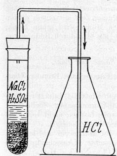
Die Darstellung der Salzsäure kann auch folgendermassen vorgenommen werden. [M.: Kochsalz, verd. Schwefelsäure, Stativ, Brenner, Erlenmeyer, Becherglas, U-förmiges und gerades Glasrohr, durchbohrter Pfropf, Lakmuslösung.]
