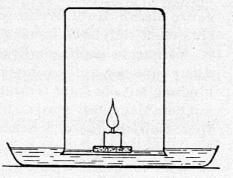
des Glases vollständig abgeschlossen ist und halte ruhig, bis die Kerze erlischt. Beobachte. (Das Wasser steht im Glase höher.) Senke das Glas so tief, dass der Wasserspiegel innen und aussen gleich hoch steht und miss, wie tief das Glas im Wasser steht (ca. ein Fünftel der Höhe).
