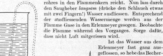
Erlenmeyer fast ganz ausgeflossen, so hebe das Becherglas hoch und entferne die Flamme. Es fliesst Wasser in das Gefäss zurück und treibt das Gas heraus, das an der Spitze der Glasröhre eine schöne Stichflamme bildet. Das Experiment kann beliebig oft wiederholt werden. Statt einer Kerze kann auch eine Weingeistflamme verwendet werden.
