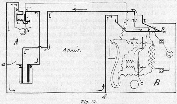
Wird der Taster T auf Station A nicht mehr niedergedrückt, so wird das ganze System stromlos und die Klingeln ertönen nicht mehr.
