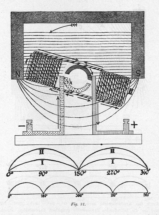
wegung des Ankers an. Anker nennen wir die Riemenwelle samt Spule und Halbringen, welche im magnetischen Kraftfelde rotieren.
