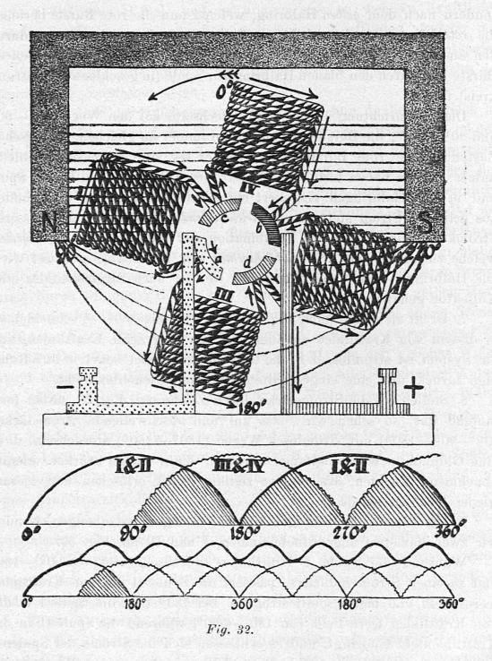
Bedingung, die erfüllt sein muss; denn nur in einem geschlossenen Leiter kann ein elektrischer Strom zirkulieren. Eine in den äusseren Stromkreis eingeschaltete Glühlampe würde von 0° bis 90° an Leuchtkraft immer mehr zunehmen, was im unteren Teil der Fig. 28 angedeutet ist.
