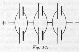
so ist die elektromotorische Kraft das Dreifache eines Elementes = 3. Der Widerstand eines Paares sinkt auf die Hälfte des Widerstandes eines Elementes, da der Querschnitt der Strombahn doppelt so gross ist, und ist somit 0,15 Ohm. Da die drei Paare hintereinander geschaltet sind, ist der gesamte innere Widerstand 3.0,15 Ohm. Es ist
