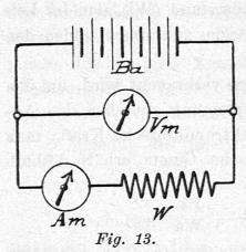
Voltmeter. Vm Fig. 13. In einen zweiten Stromkreis schaltet man das Ampèremeter Am und einen Widerstand W von 1 Ohm ein. Die Batterie wird so umgeschaltet, dass das Voltmeter 1 Volt Spannung angibt; dann zeigt der Zeiger des Ampèremeters 1 Ampère.
