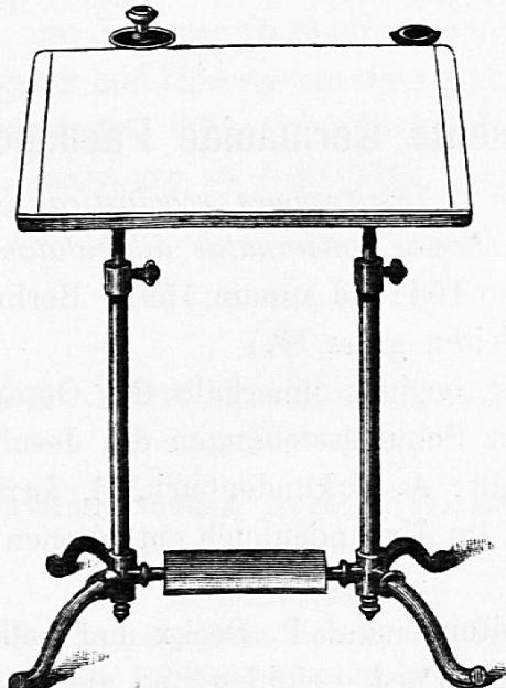
Eisensäulen von 62 cm, in denen die ebenfalls eisernen Träger des Tischbrettes, höher und niedriger schraubar, laufen. Minimalhöhe der Tischbrettstellung 65, Maximalhöhe 120 cm. Tischbrett von Eichenholz, gefirnisst auf, einer Längsseite mit Leisten versehen, beliebig schräg stellbar. Länge des
