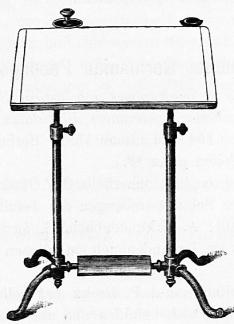
Eisensäulen von 62 cm, in denen die ebenfalls eisernen Träger des Tischbrettes, höher und niedriger schraubbar, laufen. Minimalhöhe der Tischbrettstellung 65, Maximalhöhe 120 cm. Tischbrett von Eichenholz, gefirnisst auf, einer Längsseite mit Leisten versehen, beliebig schräg stellbar. Länge des
