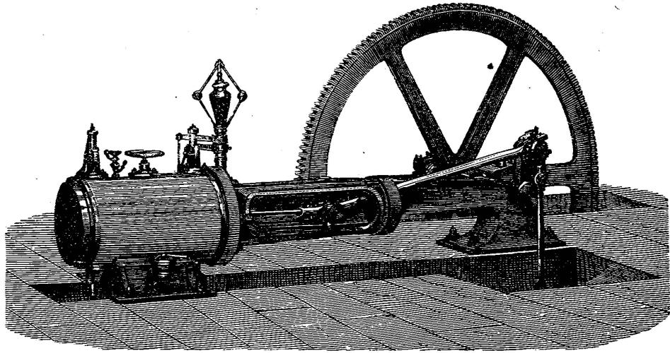
cylinder *a* mit seinem breitsohligen Untersatze *b*, der auch gleich den Condensator *c* enthält, unmittelbar auf das Mauerwerk *d* gestellt ist.
