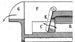
Fischer's Presspumpe mit selbstthätiger Ausrückung
