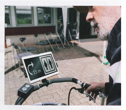
sind als flache Stücke. Beim Runtergehen bremst der Rollator sogar leicht, damit er seinem Benutzer nicht davonrollt. Das eingebaute Navigationssystem zeigt passende Wege ohne Treppenstufen oder hohes Gefälle an.
