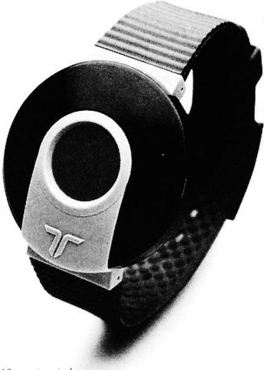
Der TeleAlarm®S10 benötigt nur einen Stromanschluss. Fällt der Strom aus, sorgt die Batterie während 48 Stunden für Ihre Sicherheit. Den Armbandsender tragen Sie am Handgelenk. So sind Sie mobil und können im Notfall jederzeit den Alarm auslösen.
