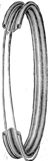
Nebenstehende Abbildung zeigt, wie die beiden endlosen Drähte des Dunlop-Pneumatics den Gummi-Mantel fest in seiner Lage halten und es leicht ermöglichen, den Pneumatic von den Stahlreifen zu entfernen. Zur bessern Veranschaulichung ist auf nebenstehendem Bilde aus einer Westwoodfelge ein Stück herausgenommen worden, während die beiden endlosen Stahldrähte ohne den Gummi-Mantel dargestellt sind.
