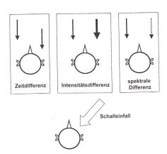
Abbildung 1: Physikalische Unterschiede des Schallsignals beim beidohrigen Hören: (links) Zeitdifferenz (mitte) Intensitätsdifferenz (rechts) Spektral-(Klang-) differenz. Ein von vorn rechts einfallendes Schallsignal erreicht das rechte Ohr früher und ist geringfügig intensiver. Außerdem unterscheidet sich die spektrale Zusammensetzung im Vergleich zu anderen Schalleinfallsrichtungen durch den Kopfschatten, die Schulter u.a.
